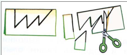
იმისათვის, რომ რთული კონტურების მქონე დეტალები გამოჭრათ, ჯერ სიცარიელენი საერთო ფორმით ამოჭერით, შემდეგ კი პატარა ნაწილები დაამუშავეთ.
